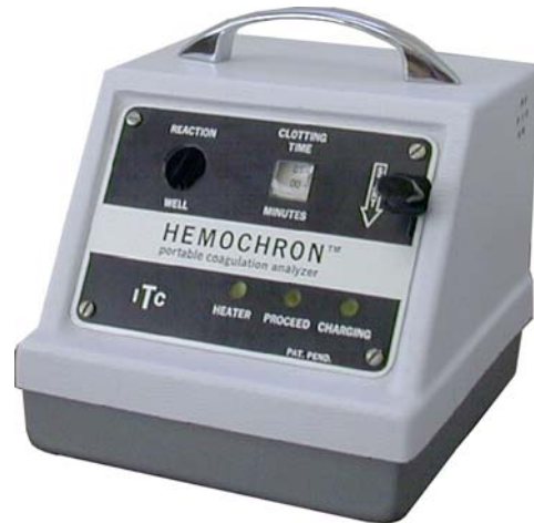
Figura 1. Hemochronometer, 1969. Strumento semiautomatico per la rilevazione del coagulo di fibrina dopo attivazione del campione con farina fossile o polvere di vetro P214.
